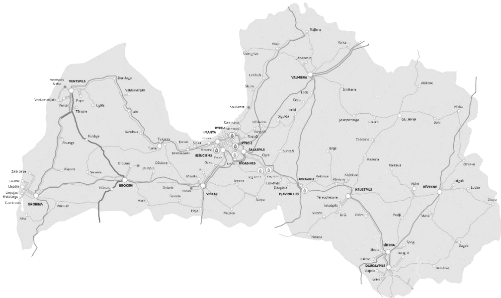
28. attēls. 330 kV un 100 kV elektropārvades līniju izvietojums 79
