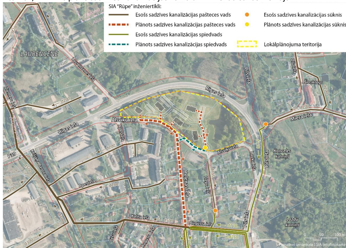
Att. 26. , 27. Princiālie sadzīves kanalizācijas tīklu un LK novadīšanas risinājumi
