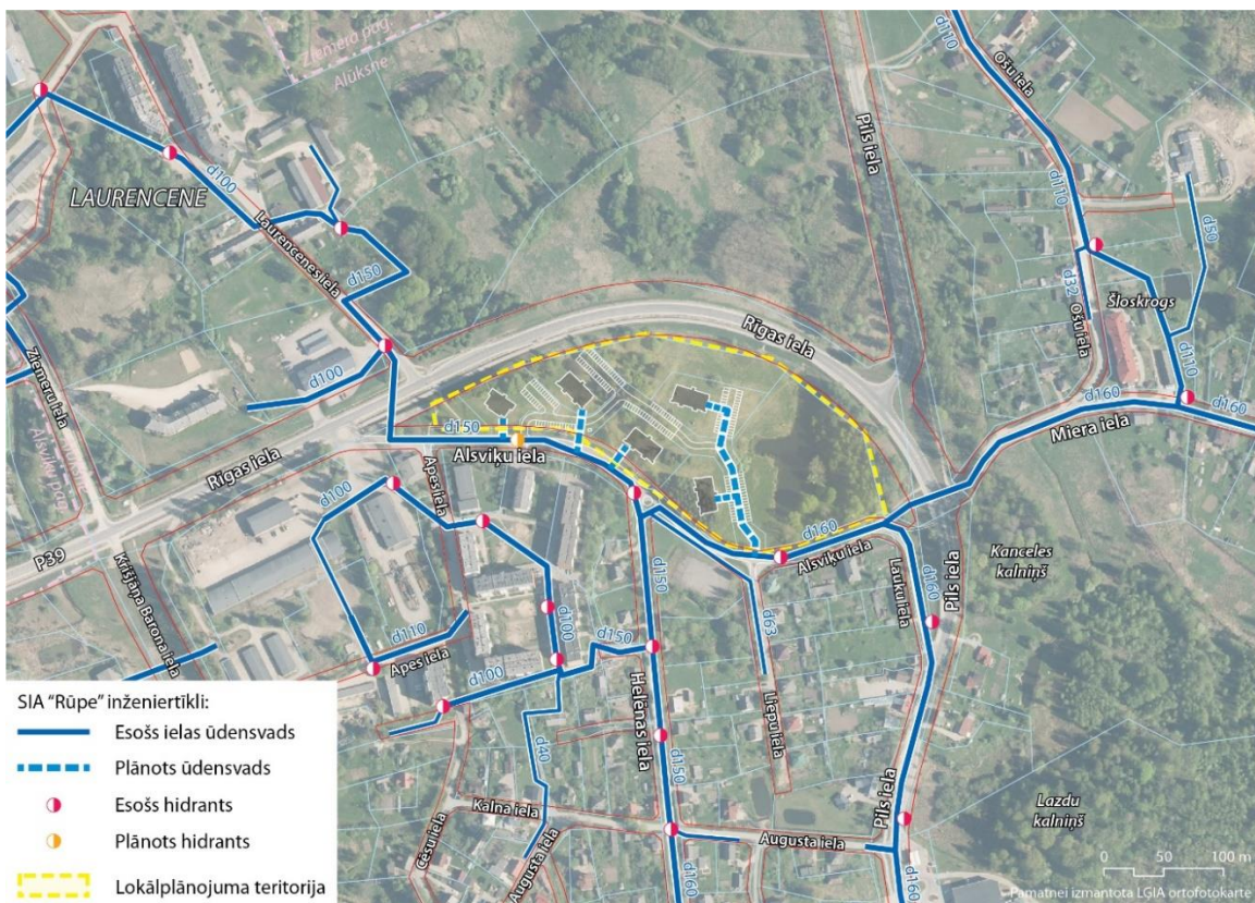
Att. 25. Principiālais centralizētās ūdensapgādes pieslēguma risinājums
